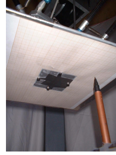
FIG. 11 – Plaquette et stylet permettant le tracé de la trajectoire.
