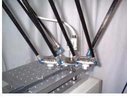
FIG. 8 – Validation de l'identification par contrainte cinématique sur l'effecteur - Configuration 1.
